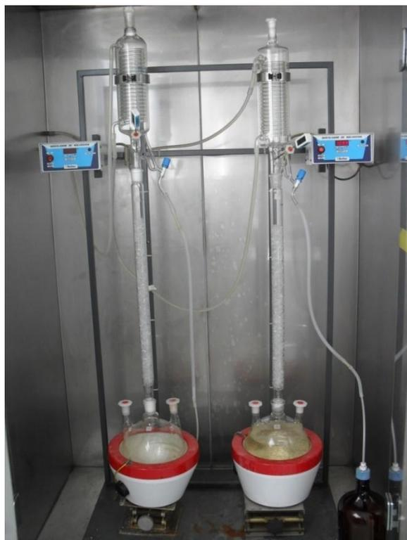
Figura 63. Sistema de destilação de Solventes
