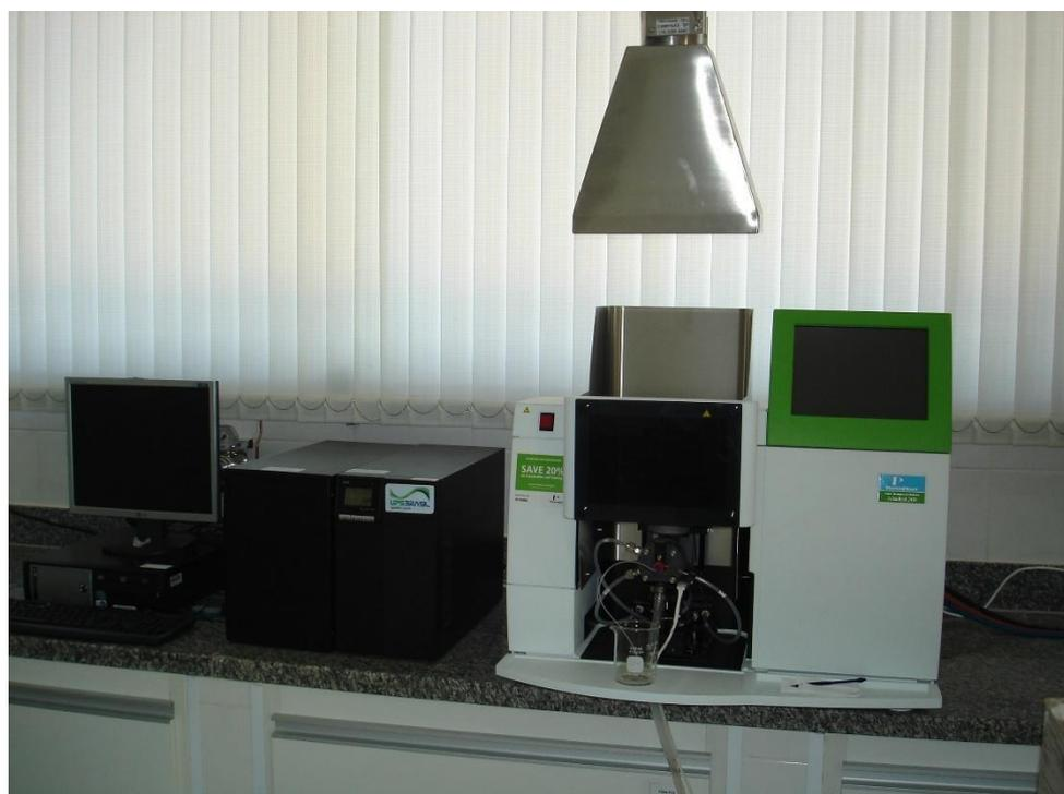
Figura 70 – Espectrofotômetro de Absorção Atômica Perkin Elmer modelo AAnalyst 200
