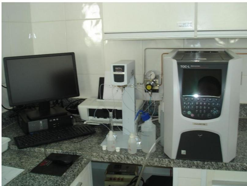
Figura 71 – Analisador de Carbono Shimadzu modelo TOC-L
