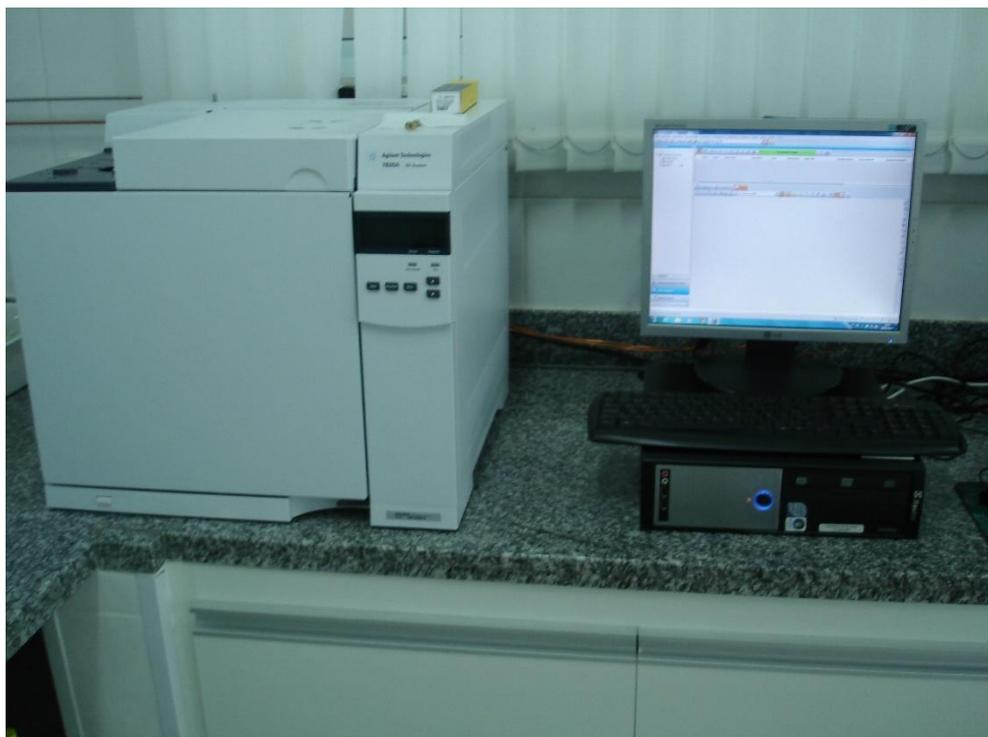
Figura 69 – Cromatógrafo Gasoso agilent modelo 7820A
