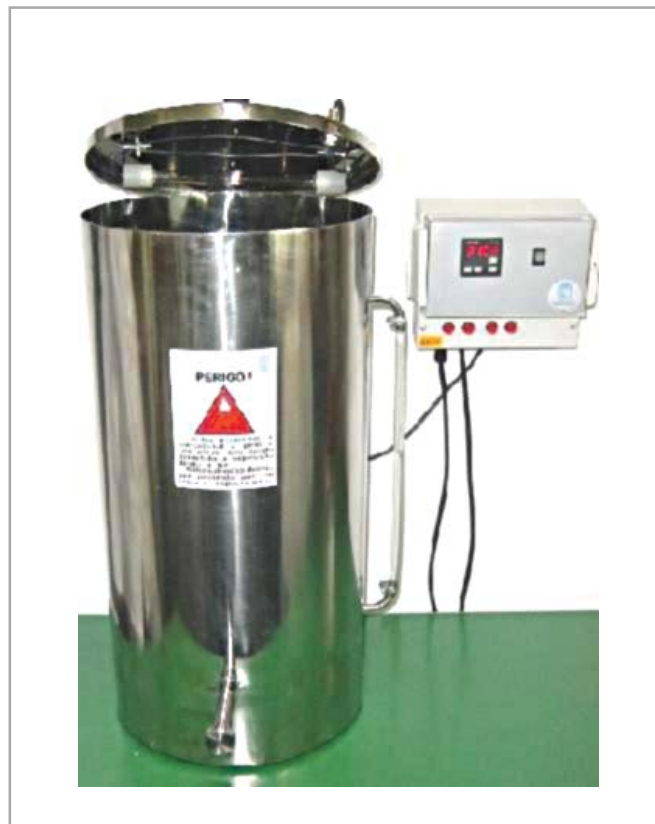
Figura 2. Recipiente para armazenamento de água em laboratórios construído em aço inox 304, contendo lâmpada UV-C (6 watts), eletrobomba para circulação de água e controlador automático.
