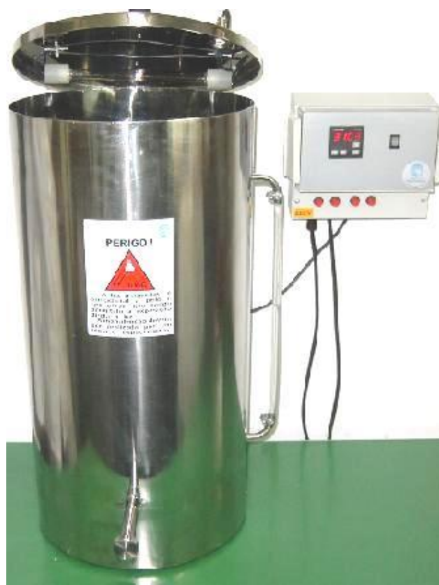
Figura 10 – Recipiente (50 L) para armazenamento de água em aço inoxidável 304 polido e com tratamento sanitário, dotado de eletrobomba de drenagem Eberle EBD 17241 (220 v / 60 hz) e lâmpada UV-C Light Express (6 watts).
