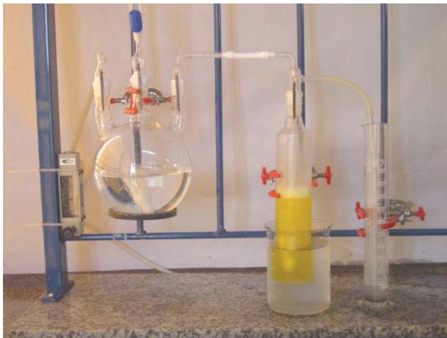
Figura 17 – Término do processo de recuperação de bromo na forma de reagente (LiBr/LiBrO em solução de LiOH 10 % m/v ) na linha especial em vidro.
