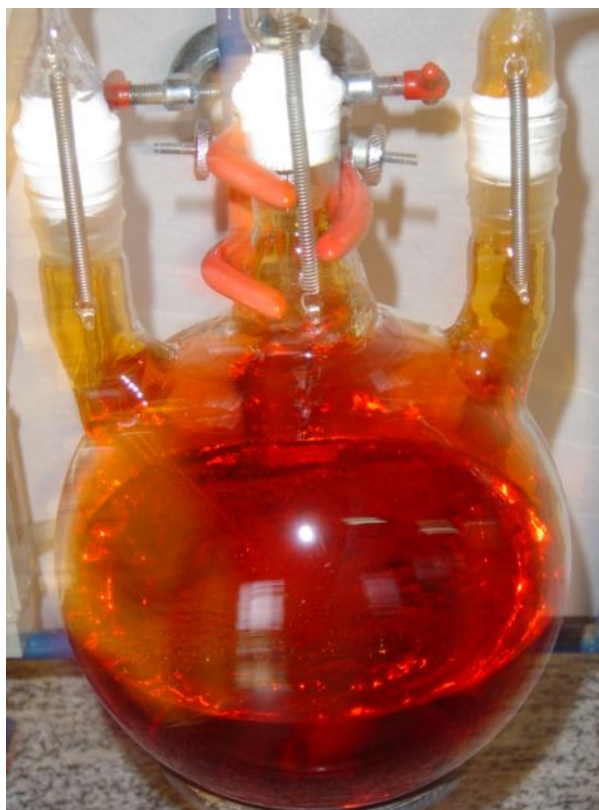
Figura 16 – Detalhe do balão de reação da linha de recuperação de bromo em solução residual, no instante da acidificação do meio e da conseqüente liberação de Br 2 .
