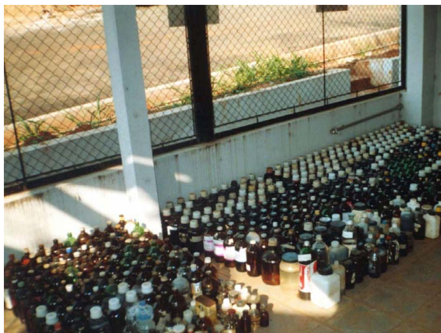
Figura 2 – Frascos contendo resíduos químicos de procedência desconhecida, armazenados no depósito de resíduos do CENA/USP.
