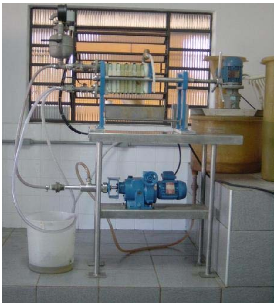
Figura 5 – Filtro prensa Netzch tipo quadro formato 175 \times 175 \text{ mm} , acoplado em reservatório em resina dotado de agitador mecânico com haste em aço inox, empregado na filtração de metais pesados precipitados em soluções residuais.
