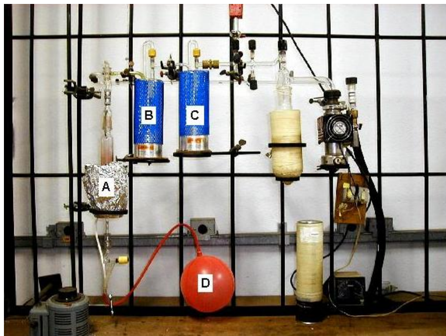
Figura 3 – Linha especial de alto vácuo para reciclagem de cobre, sendo: A) forno a 450 °C ; B) armadilha de gelo seco e etanol a -73 °C; C) armadilha de nitrogênio líquido à -196 °C; e D) balão de hidrogênio gasoso.
