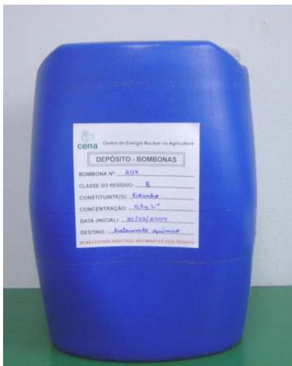
Figura 32 – Bombona de 50 L de capacidade usada para acondicionamento de resíduos químicos no depósito de resíduos, devidamente identificada com rótulo desenvolvido para essa finalidade.
