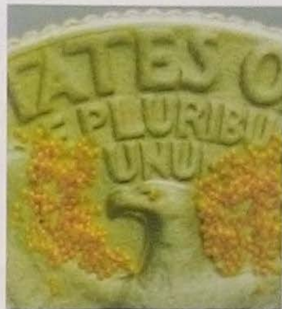
Figura 43-13 As pequenas esferas sobre a moeda foram feitas de uma mistura de deut rio e tr tio para serem usadas em uma c mara de fus o a laser. (Cortesia do Los Alamos National Laboratory, New Mexico)
