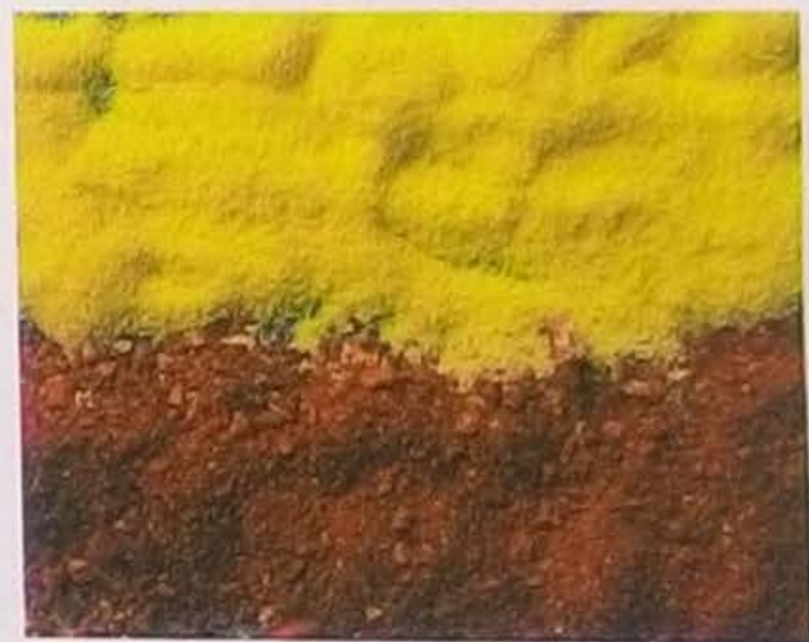
Figura 39-10 Duas amostras de seleneto de cádmio, um semiconductor, que diferem apenas quanto ao tamanho das partículas (cristalitos) que formam o pó. Cada cristalito se comporta como uma armadilha eletrônica. A amostra de baixo possui partículas grandes e, portanto, a distância entre os níveis é pequena e apenas os fótons correspondentes à luz vermelha não são absorvidos. Como a luz não absorvida é espalhada, a amostra apresenta um tom avermelhado. Na amostra de cima, que possui partículas menores, a distância entre os níveis é maior e outros comprimentos de onda não são absorvidos, o que faz a amostra adquirir uma tonalidade amarela. (Extraída de Scientific American , January 1993, p. 122. Reproduzida com permissão de Michael Steigerwald, Bell Labs–Lucent Technologies)
