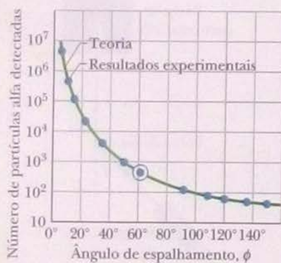
Figura 42-2 Os pontos no gráfico representam os resultados experimentais do espalhamento de partículas \alpha por uma folha fina de ouro, obtidos por Geiger e Marsden usando o equipamento da Fig. 42-1. A curva é a previsão teórica, baseada na hipótese de que o átomo possui um núcleo pequeno, maciço, positivamente carregado. Observe que a escala vertical é logarítmica e cobre seis ordens de grandeza. Os dados foram ajustados para que a curva teórica passe pelo ponto experimental envolvido por uma circunferência.
